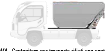
MA - Contenitore per trasporto rifiuti con contenitore sollevabile a fondo apribile
