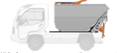
MLP - Contenitore per trasporto rifiuti con contenitore sollevabile a fondo apribile, con sollevamento bidoni e pressa per rifiuti
